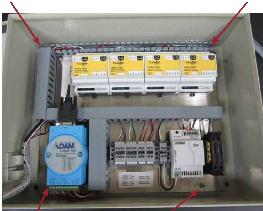
Halteschrauben für die Trägerbaugruppe
